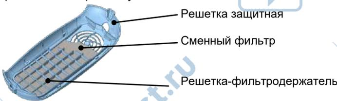
Рис.1 Фильтровальный блок со сменным фильтром
